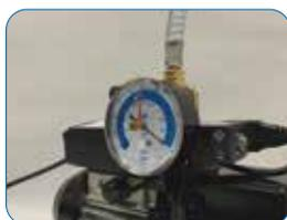
Conexión con bomba de vacío
